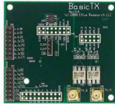
BasicTX - это недорогая дочерняя плата, которая обеспечивает возможности передачи сигналов от USRP в диапазоне от 1 до 250 МГц. В BasicTX используется два широкополос
