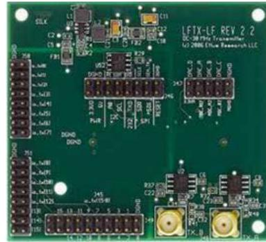
LFTX - это недорогая дочерняя плата, которая использует два высокоскоростных операционных усилителя для передачи сигналов 0 до 30 МГц. Плата LFTX идеально подходит для систем, работающих в КВ диапазоне, а также систем с внешним трактом повышения частоты. Каждый выход LFTX может использоваться независимо, либо оба выхода могут быть объединены в пару I/Q.
