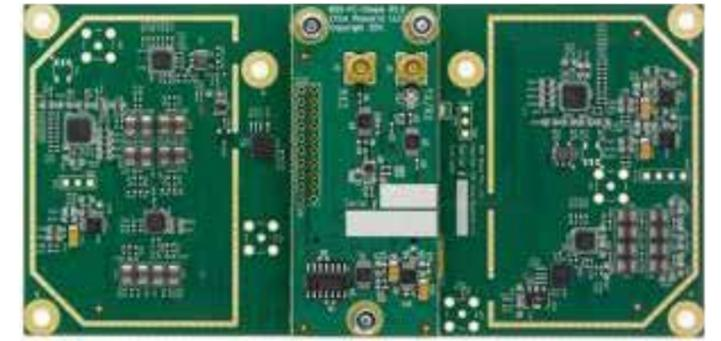
Платы WBX, SBX и CBX – это широкополосные полнодуплексные приемопередатчики, обеспечивающие до 100 мВт выходной мощности и коэффициент шума 5 дБ. Внутреннее устройство и управление этими платами аналогичны, отличия касаются частотного диапазона (см. таблицу ниже).
